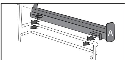
BEMÆRKNING: Den teleskopiske del af skinnen skal udfoldes ud ad ovnen, og endestoppet skal A være foran dig.
