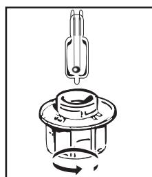
Ak žiarovky nefungujú, môžete ich vymeniť sami. Zložte tienidlo a potom odskrutkujte žiarovku (použite gumenú rukavícu, ktorá uľahčí vymontovanie). Namontujte novú žiarovku a nasadte späť tienidlo.
