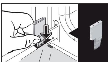
Αφαιρέστε το πρώτο στερεωμένο τζάμι: Χρησιμοποιώντας το άλλο στοπ (ή ένα κατσαβίδι), ασκήστε πίεση στις υποδοχές **A** ώστε να απασφαλίσετε το τζάμι.
