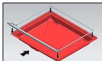
2 - Σιλικονούχος σαλιάρα με το πλαίσιο στήριξης. Τοποθετήστε το πλαίσιο πάνω στο δίσκο στάγδην πολλαπλών χρήσεων 45 mm για να συλλαμβάνει το νερό συμπύκνωσης από το φαγητό. Τοποθετήστε το στο κάτω επίπεδο 1. Η σφραγίδα σιλικόνης εξασφαλίζει ότι η πόρτα είναι στεγανή.
